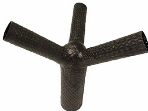
Abb. 2: Mit dem „ Materialica Design+Technology Gold Award “ in der Kategorie „Surface and Technology“ ausgezeichnete dreiarmlige Faserverbundverzweigung nach dem Vorbild der Verzweigungen des Drachenbaums. © PBG Freiburg
