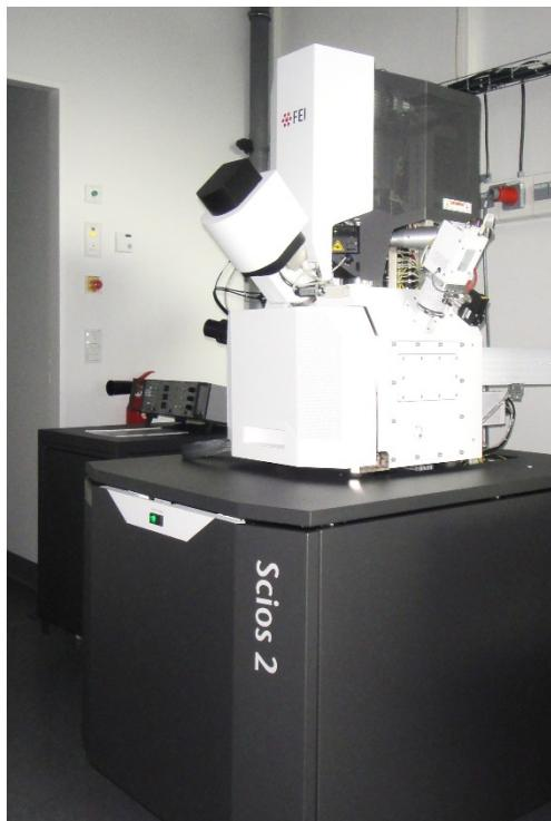
Abb. 5: FIB/SEM Anlage Scios 2 im FIT (© Thomann)
