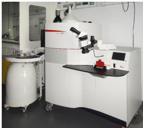
Abb. 7: Hochdruckgefrieranlage Leica ICE im FIT (links Leica EM AFS2), (© Thomann)
