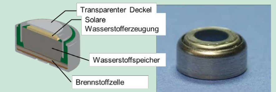
Abb. 2: Selbstladende Knopfzelle (Schema und Muster)
