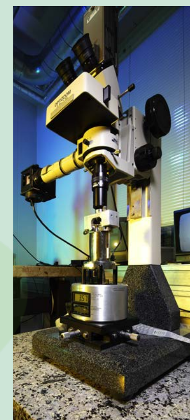
Mit dem AFM (atomic force microscope) werden Proben untersucht und neue Analysemethoden entwickelt.
